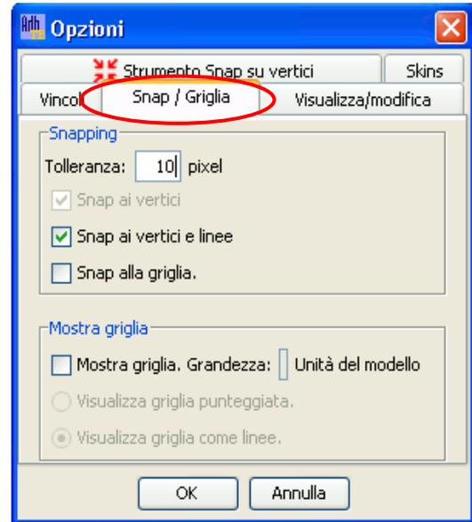
L'impostazione dello *snapping* è molto importante quando si opera nell'ambito di un SIT, in quanto consente di garantire la congruenza geometrica nel modello virtuale che traduce nella logica del calcolatore le entità reali, al fine di poter condurre analisi specifiche e garantire la correttezza topologica..
