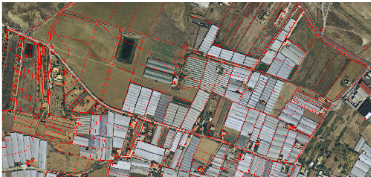
Fig. 2 – Esempio di applicazione del grigliato NTV2 relativo al Comune di Licata (AG)
