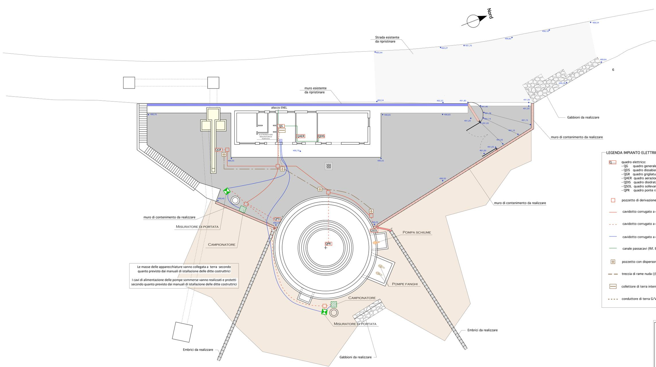
Le masse delle apparecchiature vanno collegata a terra secondo quanto previsto dai manuali di installazione delle ditte costruttrici
