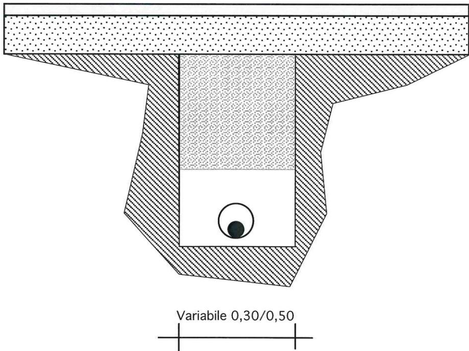
Particolare sezione di scavo - R = 1:10
